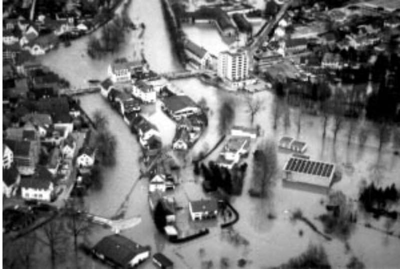
An der Einmündung von Nebenflüssen ist die Überschwemmungsgefahr aufgrund von Rückstauwirkungen erhöht.
